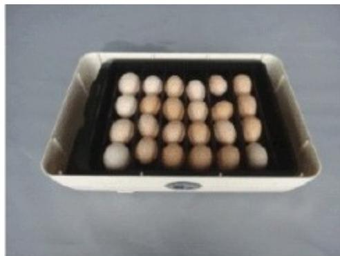
**Рис. 3:** Положите подвижной поток для яиц на сетчатую пластину и поставьте перегородки в зависимости от размера яйца для инкубации, ширина каждого отделения должна быть на 5-10мм больше диаметра яйца, чтобы обеспечить хороший безприпятственный поворот яиц.
