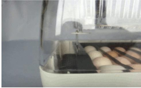
**Рис. 4:** Обратите внимание, что для обеспечения поворота яиц есть стержень, выступающий из верхней- прозрачной части инкубатора. Стержень должен быть вставлен в канал подвижного лотка, таким образом будет происходить поворот яиц. Двигатель работает постоянно при включении инкубатора в сеть. Цикл поворота яиц проходит за четыре часа.
